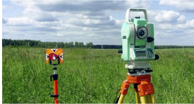
13 Сурет – Кен орнында қолданылатын Leica TS15 тахеометрі
