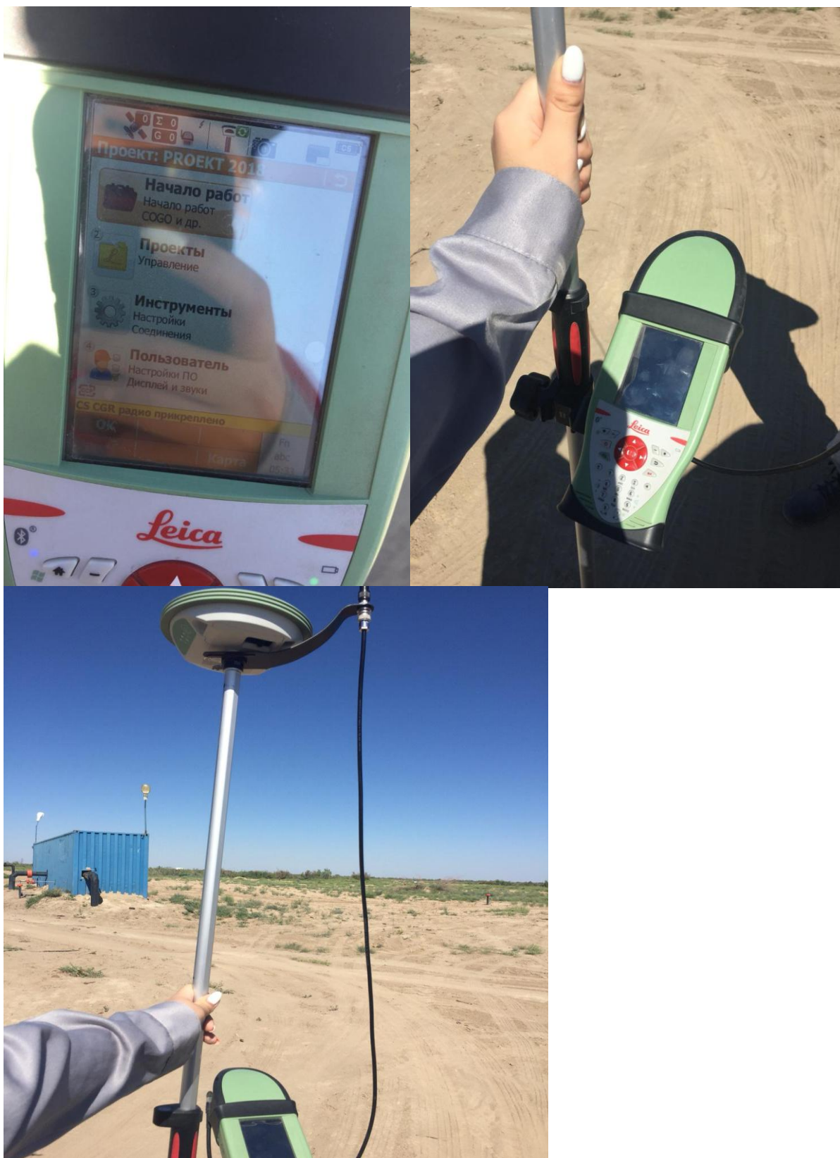
15 Сурет – Өндірістік практикада мен жұмыс жасап үйренген құрал Leica GS14 GSM/UHF, Rover CS15
