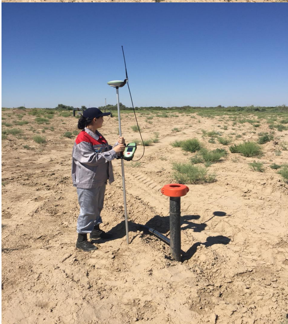
16 Сурет – Ұңғымаларды GPS құрылғысы арқылы параметрлерін алып картаға түсіру процесі.
